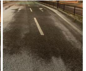
路面への定着性と車両通行による引きずり効果により、凍結防止効果が広がりを見せている。
