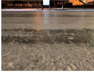
散布前の路面は、すでに凍結が始まっており、通常タイヤでの車両走行では危険な箇所あり。氷膜平均0.5mm。
